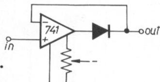
Un diodo abbinato a un operazionale nel modo rappresentato in figura 22 presenta invece una « caratteristica » perfettamente lineare. Vediamo il perché.
