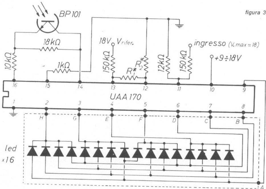
Esempio di voltmetro con indicazione « a pallini » da 0 (oppure 3) a 18V.
