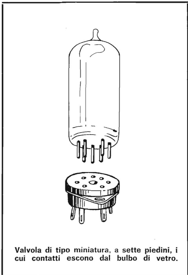
Anche il problema pratico è semplice da risolversi: si prende la valvola in mano con la base munita dei piedini rivolta verso il viso dell'operatore; quindi si comincia a contare in senso orario (ossia nel senso di avanzamento delle lancette dell'orologio) da uno fino a che non si finisce il giro, cominciando da un piedino che risulta differenziato rispetto agli altri.
