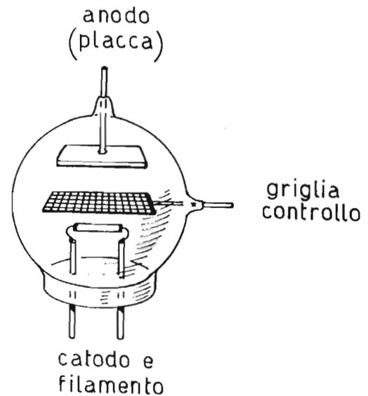
Disegno elementare, ma oltremodo esplicativo, della valvola elettronica denominata triodo. Rispetto al diodo, questa valvola contiene un terzo elemento in più: la griglia controllo, interposta fra la placca e il catodo.
