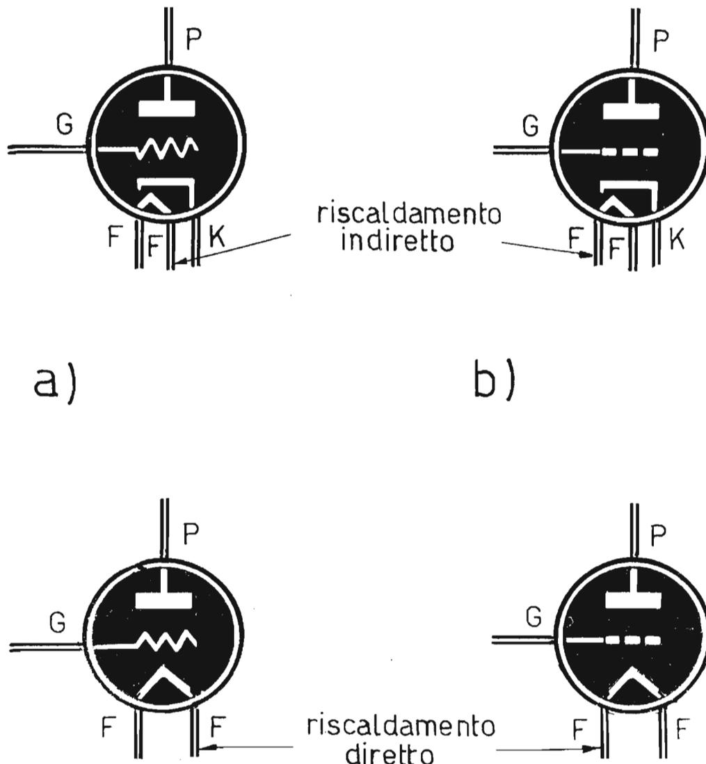
Le valvole elettroniche possono essere di tipo a riscaldamento diretto, oppure a riscaldamento indiretto. Nel primo caso è il filamento che emette direttamente gli elettroni destinati a comporre il flusso elettronico; nel secondo caso (riscaldamento indiretto) il filamento funge esclusivamente da sorgente termica e gli elettroni vengono emessi dal catodo. Nei simboli, qui riportati, la griglia risulta diversamente disegnata.
