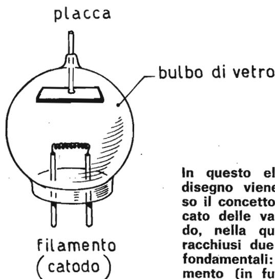
In questo elementare disegno viene espresso il concetto semplificato delle valvole diodo, nella quale sono racchiusi due elettrodi fondamentali: il filamento (in funzione di catodo) e la placca.
