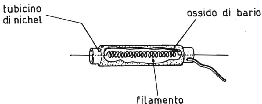
Il filamento, nelle valvole elettroniche di tipo a riscaldamento indiretto, è sempre montato dentro il catodo, che è costituito da un tubicino di nichel rivestito di ossido di bario.
