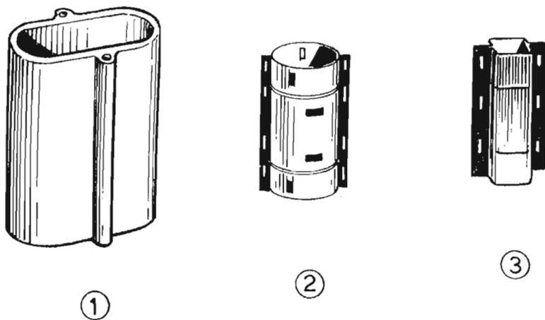
Tre diversi tipi di placche (anodi) normalmente montate nelle valvole elettroniche.
