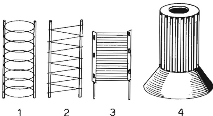
Le griglie, a seconda del tipo di valvola elettronica e della casa costruttrice, possono essere diversamente concepite.
