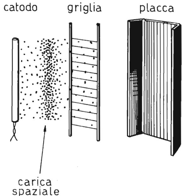
Gli elettroni emessi dal catodo costituiscono la carica spaziale; questa, per poter raggiungere la placca, deve attraversare la griglia controllo che, a seconda del modo con cui è polarizzata, concede alla carica spaziale di formare un flusso di corrente più o meno intenso.
