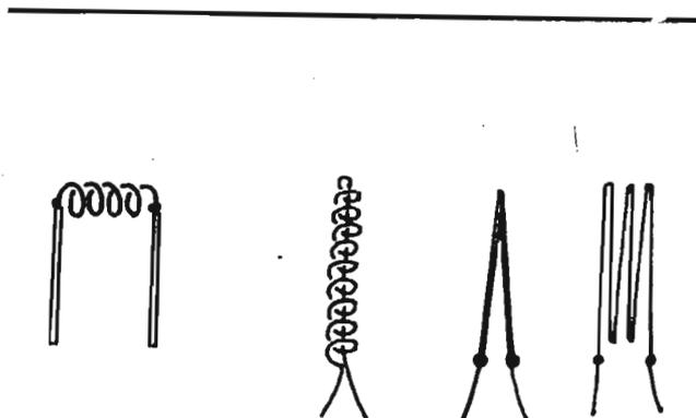
A seconda del tipo e della casa costruttrice delle valvole elettroniche, i filamenti possono essere diversamente costruiti. Anche i disegni rappresentativi del filamento possono apparire, nella letteratura tecnica, sotto forme espressive diverse.
