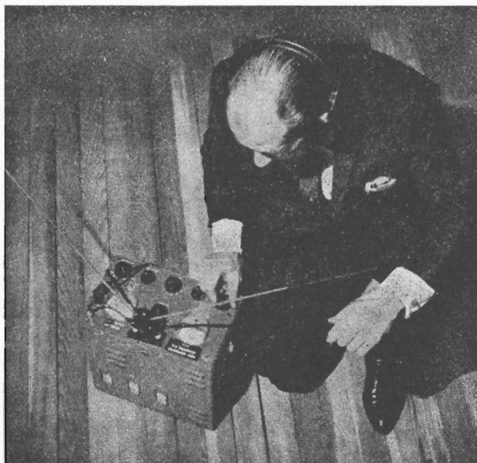
**Foto E** - In questa fotografia è mostrato il rivelatore senza fili usato come « spia ». Questo dispositivo è stato impiegato nelle ambasciate e in altri luoghi diplomaticamente « sicuri ». Abbraccia una gamma molto vasta di frequenze.
