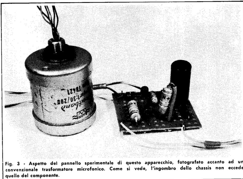
Fig. 3 - Aspetto del pannello sperimentale di questo apparecchio, fotografato accanto ad un convenzionale trasformatore microfonico. Come si vede, l'ingombro dello chassis non eccede quello del componente.
