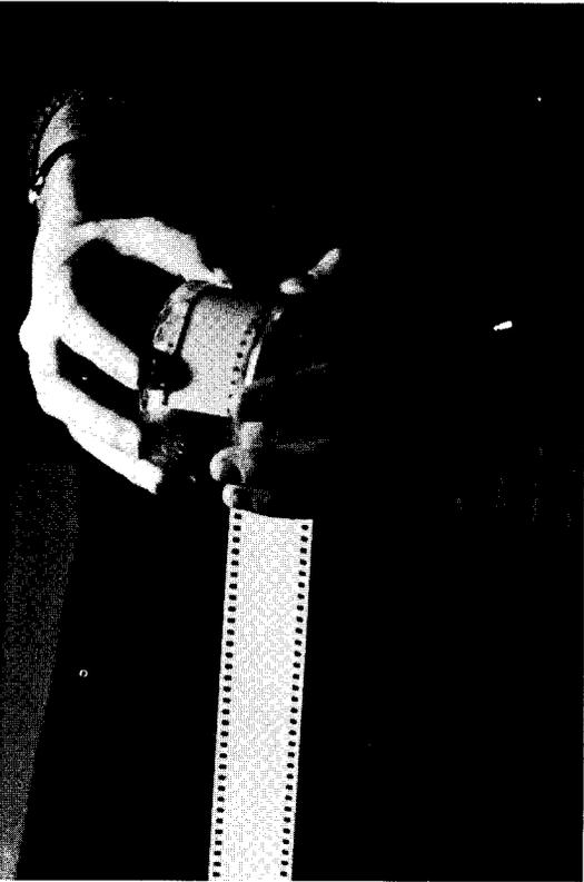
**Foto 2 - Come avvolgere il film. Introdurre nella spirale una estremità del film, si procede fino al suo completo avvolgimento, tenendo ferma la parte sinistra, di chi opera, della spirale, si ruota la parte destra alternativamente avanti ed indietro, finché la pellicola sarà completamente avvolta. Da notare che questa operazione deve essere fatta al buio.**
