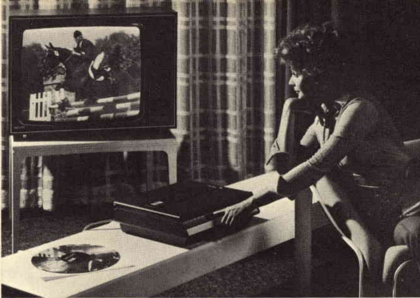
Fig. 1 - Il giradischi VLP è di impiego estremamente flessibile: può fornire immagini a colori ferme e a velocità variabile in senso diretto e inverso; si può inoltre collegare direttamente ad un televisore. Il videodisco, inciso con microscopiche tacche che contengono tutte le informazioni, porta su una faccia un programma della durata massima di 45 minuti.
