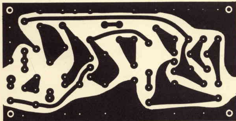
Fig. 4 - Rappresentazione delle connessioni stampate sulla bassetta recante i componenti del circuito di figura 3.
