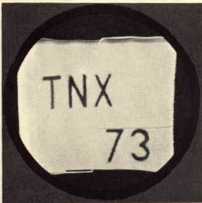
Fig. 13 - Questa immagine è la stessa della precedente, ma in negativo. L'inversione è stata ottenuta per merito dell'accorgimento descritto nella prima parte di questo articolo. Si noti la leggera traccia di ritorno, attenuata fortemente da una buona regolazione del potenziometro del contrasto e della luminosità.
