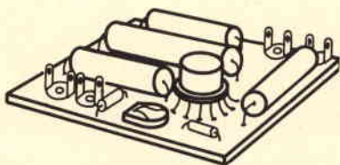
Fig. 5 - Esempio di come si presenterà il preamplificatore B.F. a montaggio ultimato.
