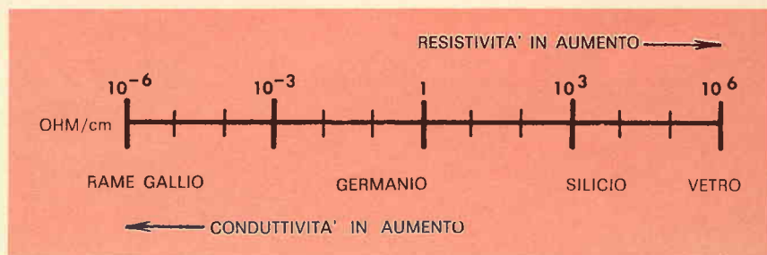
Fig. 1 - Scala simbolica, tracciata per mettere in evidenza la graduale variazione della resistività e della conduttività, nel passaggio dai materiali conduttori a quelli isolanti, e viceversa.
