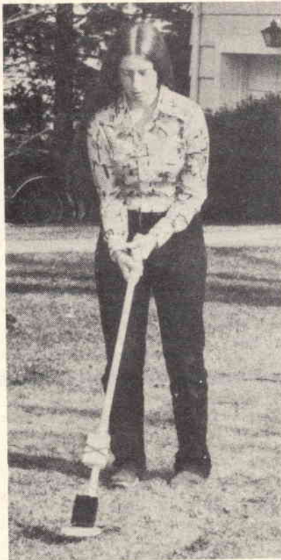
Fig. 2 - Cercametalli semi-giocattolo adatto ai principianti. A fior di terra si nota la "testa esploratrice" che sostiene la bobina sensibile agli eventuali trovati. Nella scatoletta scura subito sopra, è contenuto l'oscillatore RF di figura 3. Il radiorecettore che manifesta le variazioni del campo elettromagnetico, per essere facilmente recuperabile (non deve essere infatti modificato), è tenuto aderente all'asta lignea di supporto con un semplice elastico incrociato.
