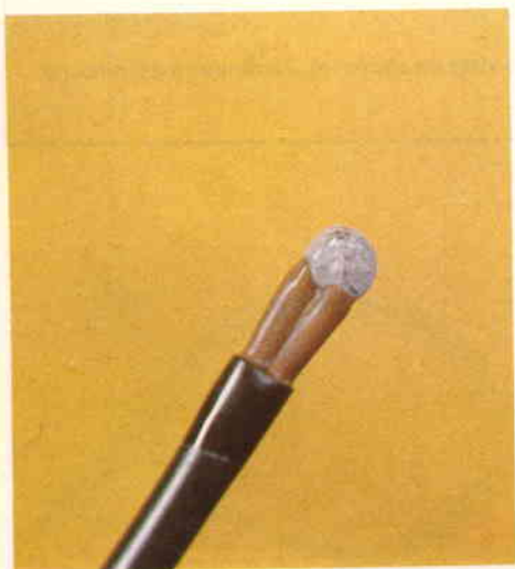
Foto 4 - Particolare della sonda in cui si notano le guaine e la vetrificazione della testa.
