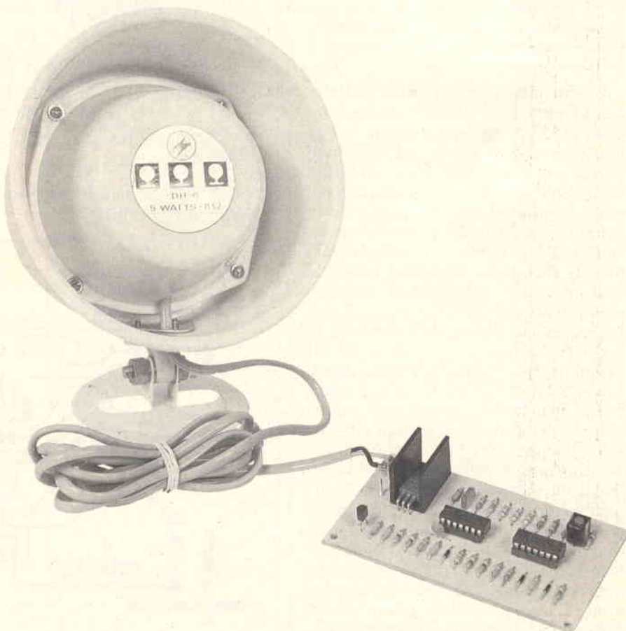
Scheda MK 220 collegata ad una sirena avente le caratteristiche da noi consigliate.
