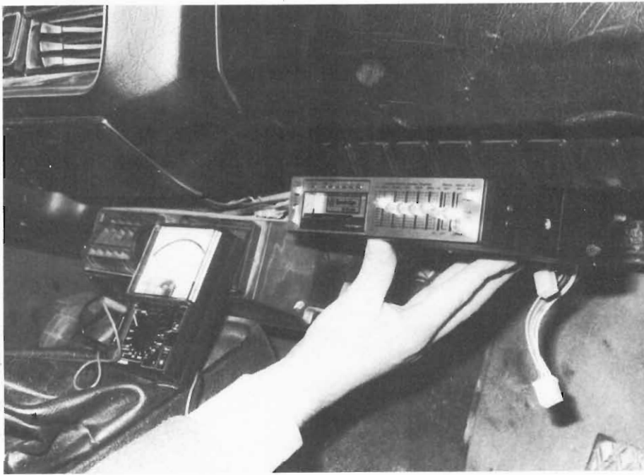
L'amplificatore - equalizzatore stereo munito di riproduttore di cassette "KC/5515-00" a montaggio meccanico ultimato (si noti la staffa a cavaliere in posizione). A questo punto è necessario procedere alle connessioni elettriche. Sulla destra si osservano le prese di uscita per gli altoparlanti.
