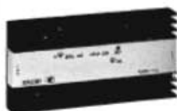
BRL 40 amplificatore lineare Potenza d'ingresso 0.2-4 W AM. Potenza uscita 70 W AM. Tensione alimentazione 12-15 V c.c.
