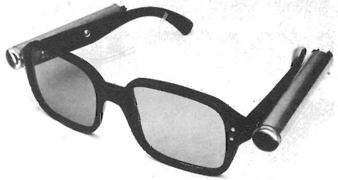
Fig. 2 - Vista dettagliata del sistema "Seeing Aid" del dottor Mins. Il sistema che trasmette gli impulsi infrarossi, è racchiuso nel tubo che si vede sulla destra della fotografia. Il sistema che capta gli infrarossi riflessi è compreso nel tubo che si scorge sulla sinistra della foto. Da questo sporge anche il tubicino che porta i segnali di avviso all'orecchio del non vedente. Sul fronte dei tubi, si sorgono i sistemi ottici che assicurano la corretta diffusione del raggio e la captazione ad alta sensibilità.
