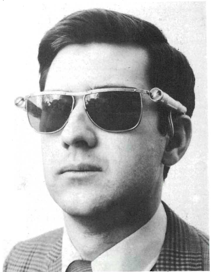
Fig. 1 - Il "Seeing Aid" un ausilio elettronico in miniatura a forma di occhiali che consente ai non-vedenti di circolare senza imbattersi in ostacoli, inforcato dal suo inventore, il dottor Forrest M. Mins, di Albuquerque, Nex Mexico, U.S.A.. Il "Seeing aid" funziona sul principio della trasmissione, della riflessione e della captazione d'impulsi di raggi infrarossi. Sia il sistema che irradia gli impulsi infrarossi, che quello che li riceve, sono contenuti nei due cilindretti che si notano montati sulle stanghette degli occhiali.
