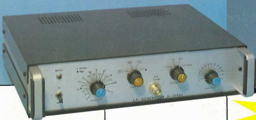
Generatore di segnali BF
