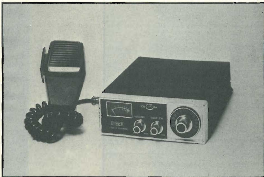
Fig. 1 - Vista frontale del baracchino CB a 40 canali Elbex distribuito dalla G.B.C. Italiana.
