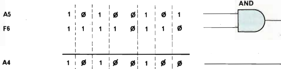
Fig. 5 - Come il microelaboratore esegue l'operazione A.
