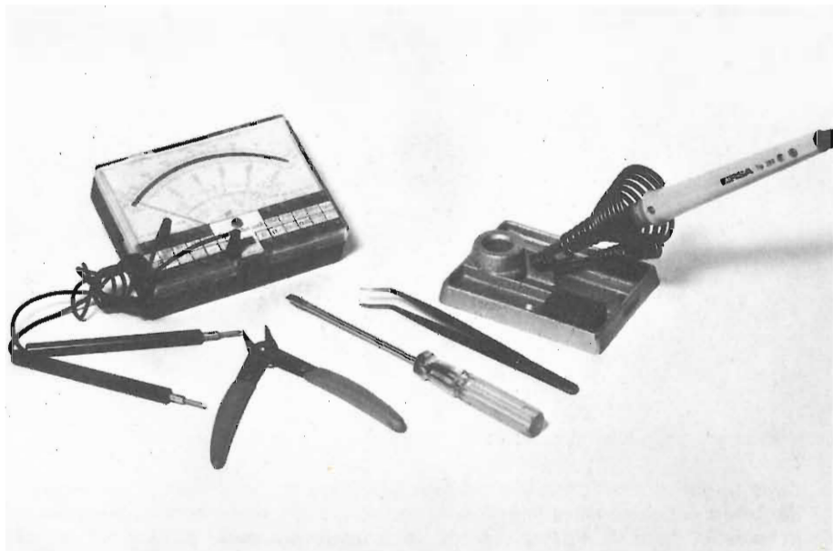
Fig. 2 - Attrezzatura indispensabile per il montaggio del microelaboratore. Raccomandiamo saldatore e stagno di qualità perché dalla bontà delle saldature dipende in massima parte il successo di un buon funzionamento.
