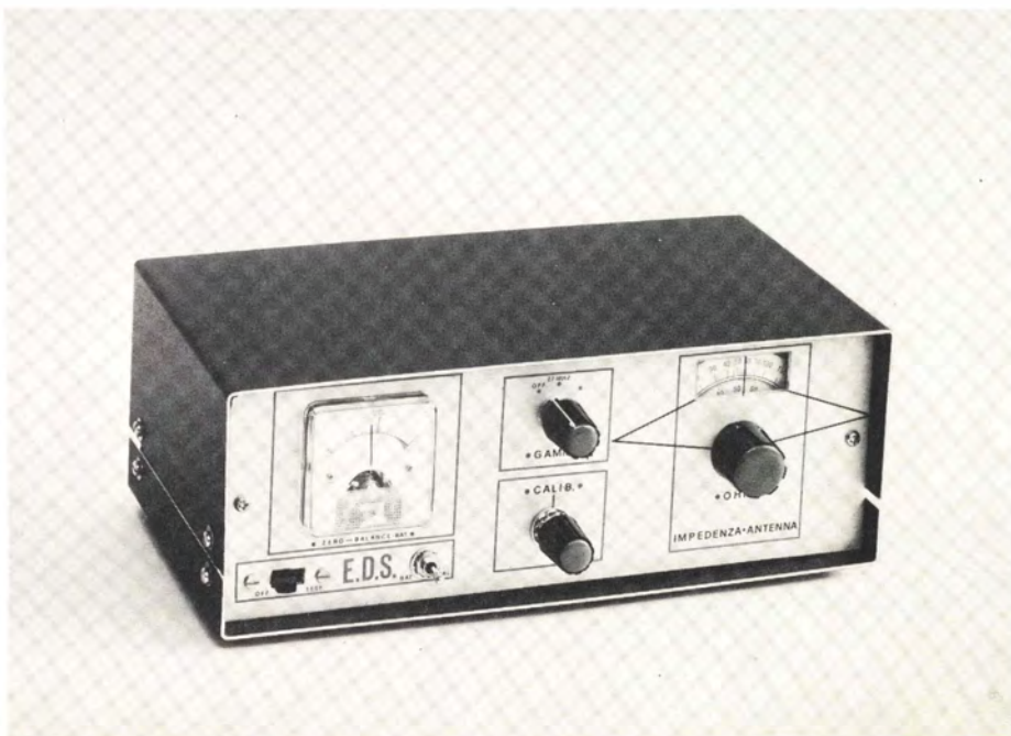
Altra vista del misuratore dell'impedenza per CB.
