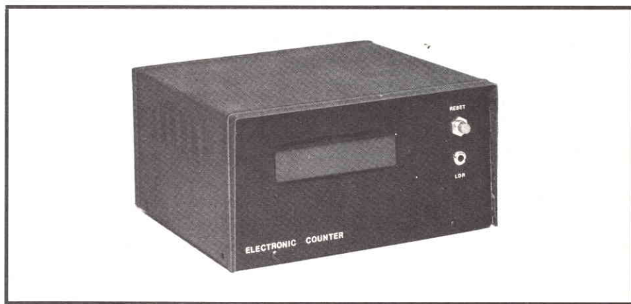
Vista esterna del contapezzi a realizzazione ultimata.
