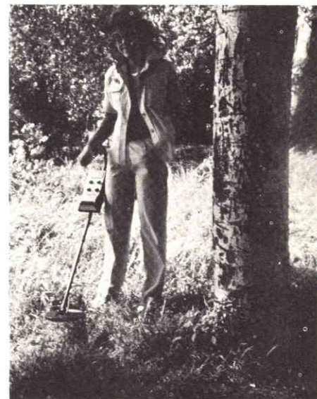
Fig. 3 - Trovando un terreno molto mineralizzato tenere la padella a circa 50 cm dal terreno, come da figura.
