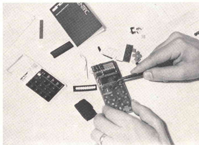
Fig. 9-C - Questa foto illustra i tre condensatori elettrolitici installati nelle rispettive posizioni, e chiarisce anche come deve risultare dopo il montaggio, l'unità di indicazione numerica UR. La foto chiarisce la anche la posizione dei tre circuiti integrati.
