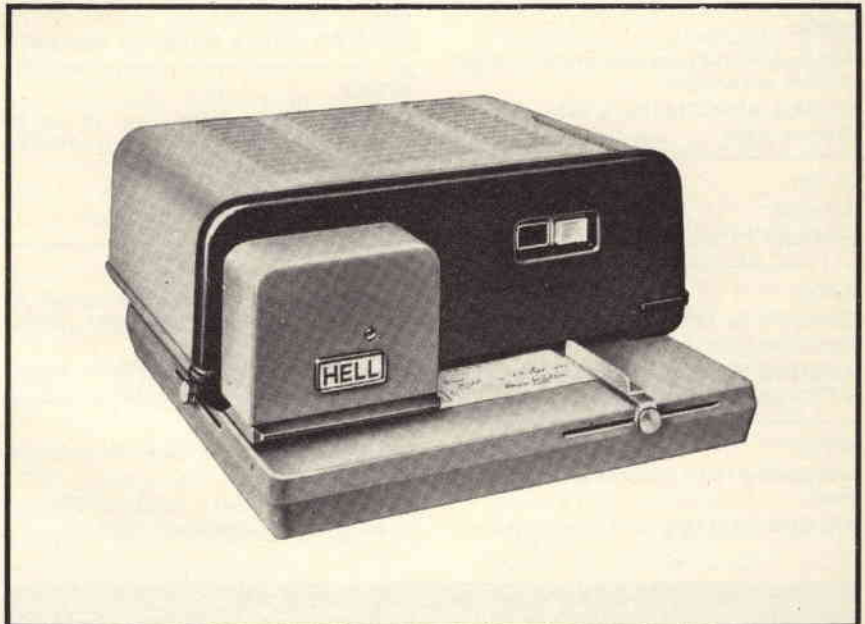
Fig. 6 - Sistema per fac-simile ridotto della HELL, Zetfax, Geber HT 236 per la trasmissione e la ricezione di testi aventi piccolo formato.
