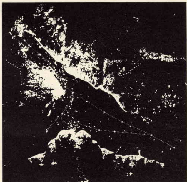
Fig. 3 - La stessa zona illustrata in figura 2 osservata sullo schermo panoramico di un radar della Decca (PPI).
