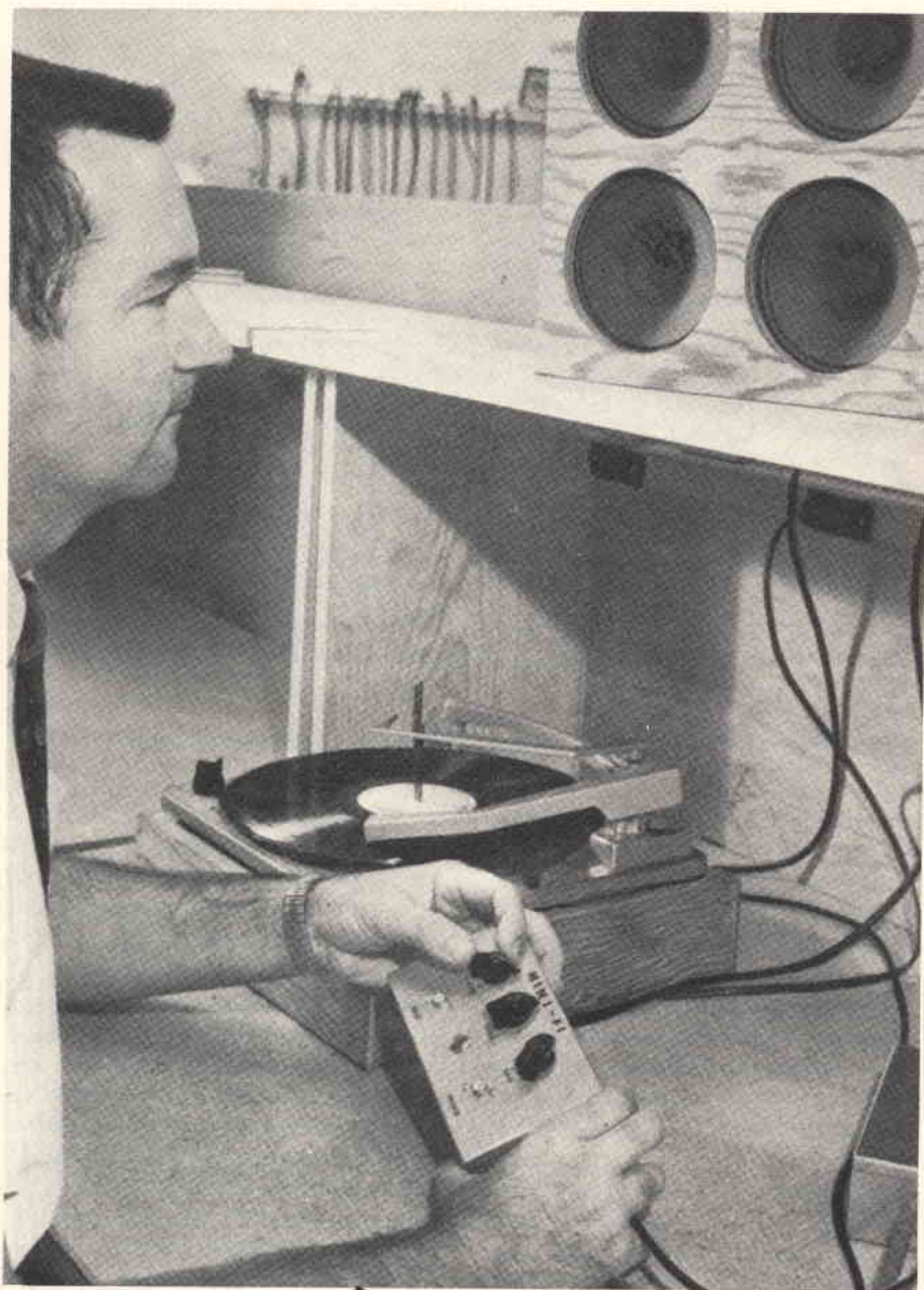
Fig. 6 - I raccordi d'ingresso e d'uscita, per il collegamento della sorgente di segnale e per l'altoparlante, possono essere applicati sul pannello frontale.
