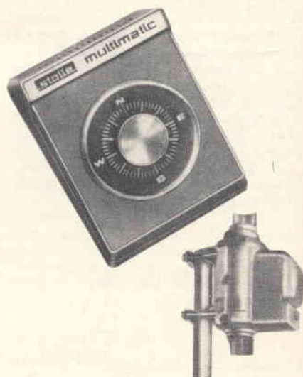
Fig. 17 - Rotore per antenne CB, Radioamatori e televisive della Stolle (GBC Italiana) corredato di telecomando automatico.
