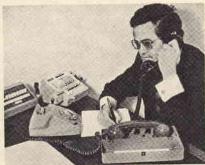
Fig. 3 - Dispositivo di segretezza con codice a 25 combinazioni, di tipo portatile, per comunicazioni telefoniche. Uno speciale accoppiatore permette il collegamento al telefono senza che sia necessaria alcuna connessione.
