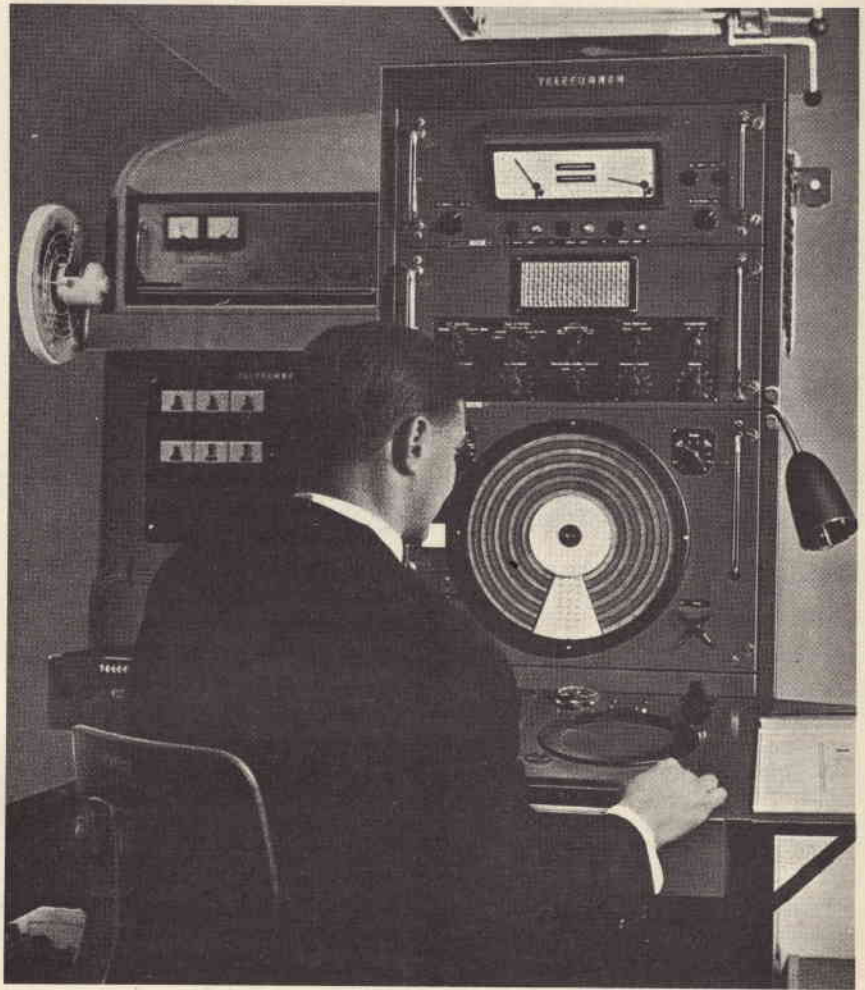
Fig. 8 - Moderno radiogoniometro tipo Adcock della Telefunken funzionante nella gamma 1,3 \div 25 MHz.
