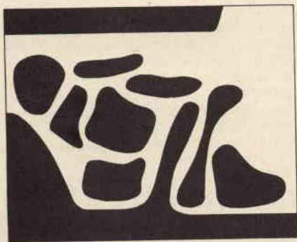
Fig. 19 - Aspetto del disegno originale del circuito stampato, attraverso il quale viene ricavata la matrice mediante carta carbone, di cui alla figura 18-A. Questa tecnica di realizzazione permette un notevole risparmio di tempo.
