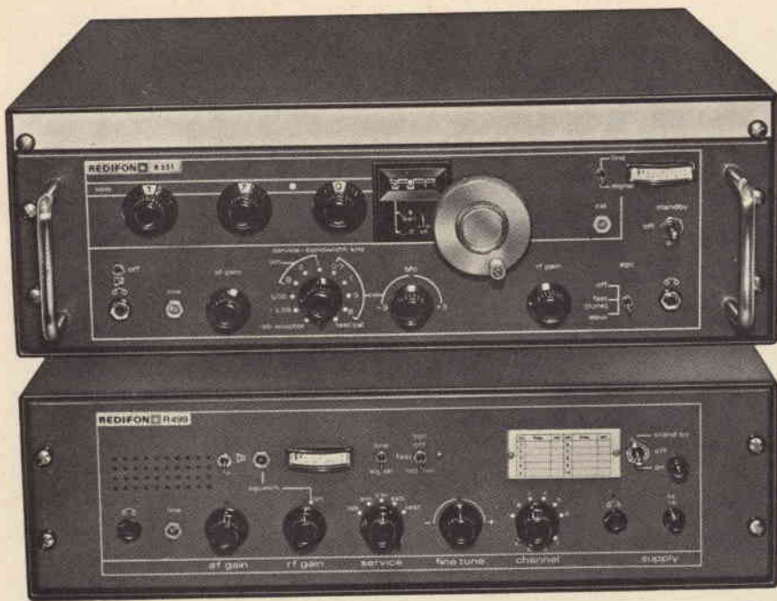
Fig. 5 - Due ricevitori professionali della Redifon Telecommunications. Il primo R551, munito di sintetizzatore per sintonia continua nella gamma fra 15 kHz e 30 MHz, ed il secondo con commutatore a dieci canali nelle gamme 255 - 525 kHz, 1,5 - 30 MHz. Entrambi sono adatti per la ricezione di qualsiasi tipo di servizio.
