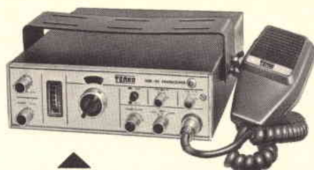
▲ Ricetrasmittente Tenko Jacky 23 5 W-AM - 15 W-SSB 23 canali equipaggiati di quarzi
