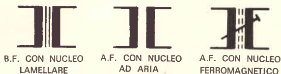
Fig. 16 - Tre diversi tipi di trasformatori, e precisamente, da sinistra a destra: trasformatore con nucleo a struttura lamellare, per bassa frequenza, trasformatore per alta frequenza con nucleo ad aria, e trasformatore per alta frequenza con nucleo ferromagnetico, di tipo regolabile.
