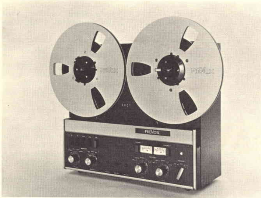
Fig. 5 - Revox A-77 Mark III con bobine in alluminio. Sia queste bobine, di notevole effetto estetico, che quelle in materiale plastico di fig. 2, con un diametro di 26,5 cm, permettono una capacità fino a 1100 m di nastro del tipo 601 specialmente studiato e consigliato per i registratori Revox.
