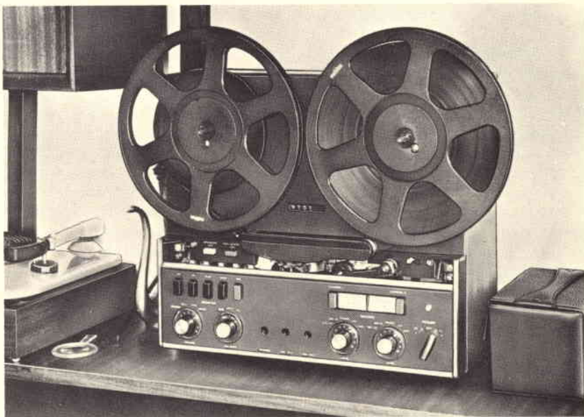
Fig. 2 - Vista frontale del Revox A-77 Mark III. Si notino le bobine da 26,5 cm di diametro, il numeratore per l'avanzamento del nastro a 4 cifre e la praticità della disposizione dei comandi. Lo sportello copritestine è stato abbassato per dare un'idea della cinematica.
