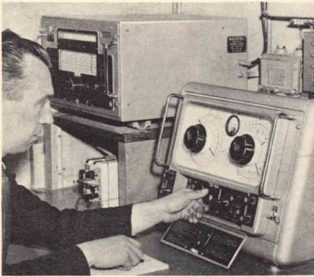
Fig. 2 - Un radiogoniometro automatico Marconi installato a bordo della nave meteorologica «Weather Adviser».
