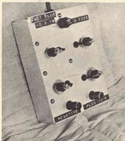
Fig. 2 - Aspetto del divisore a tensione costante e realizzato con quattro soli diodi, che può essere usato vantaggiosamente quando la tensione non supera il valore di 6,5 V.
