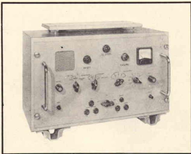
Fig. 3 - Apparecchio radiotelegrafico di Allarme Marconi tipo N2010 e N2011 funzionante sulla frequenza di 500 kHz.
