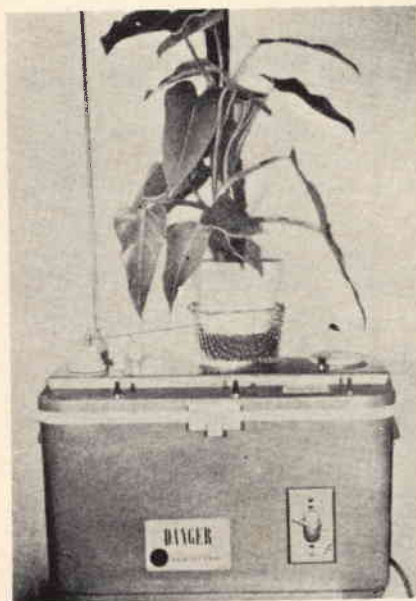
Fig. 2 - Per evitare che gli animali, i bambini, o gli estranei possano correre pericoli per contatto accidentale con l'impianto, è possibile compiere l'esperimento nel modo illustrato in questa foto. Il cestino metallico nel quale è introdotto il vaso, che costituisce il polo negativo della sorgente di alta tensione, è stato disposto in modo tale da evitare una forte differenza di potenziale verso massa. Naturalmente, l'astina metallica verticale rappresenta l'elettrodo più pericoloso.
