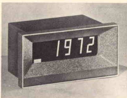
Fig. 7 - Aspetto di un dispositivo di riproduzione numerica a cristalli liquidi e di tipo trasmissivo, disponibile in commercio con un costo relativamente ridotto. Negli Stati Uniti un pannello di questo tipo costa solo un dollaro per cifra.
