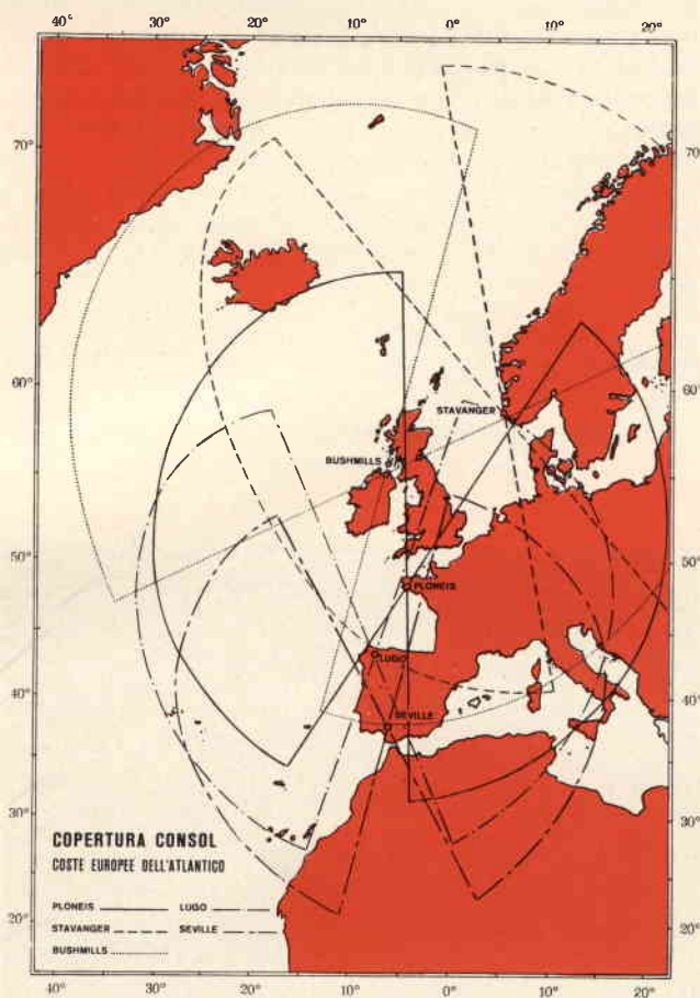
Fig. 1 - Copertura con radiofaro CONSOL. La stazione italiana interessata è installata a Lugo (carta nautica inglese L1, francese 3007 bis, 5015 bis, 5016 bis, tedesca 239C e 292C).
