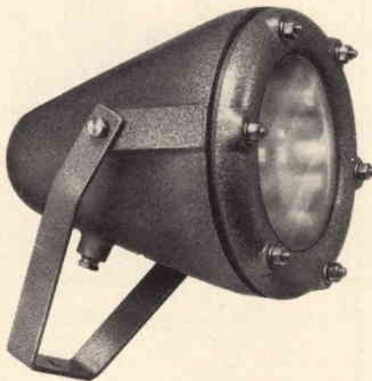
Fig. 4 - Proiettore subacqueo, o per esterni, della ditta POLLICE per lampade speculari da 150 W in vetro satinato. Corpo fuso in lega di alluminio, con schermo frontale in vetro infrangibile trasparente con doppia garanzia.
