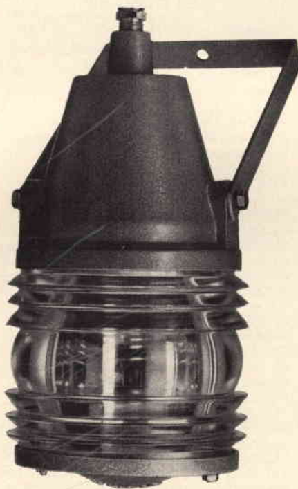
Fig. 5 - Proiettore per esterno della ditta POLLICE per illuminazione di sorveglianza, con ampia illuminazione orizzontale. La lente di Fresnel è circolare, cioè è costituita da un cilindro completo. L'illuminazione da 360° può essere ridotta a 240° e a 180° con riflettore interno.
