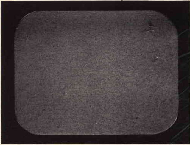
Fig. 2 - L'immagine manca sullo schermo, ma è visibile il raster ed un certo rumore di fondo.
