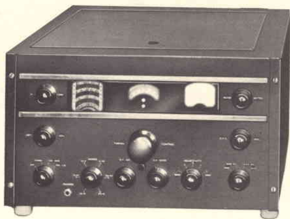
Fig. 1 - Due apparati «Surplus» più frequentemente utilizzati dai radioamatori per la ricezione di trasmissioni in telescrivente. A sinistra il famoso ricevitore della RCA a copertura continua da 500 kHz a 32 MHz AR88, a destra l'altrettanto famosa telescrivente americana TG7.
