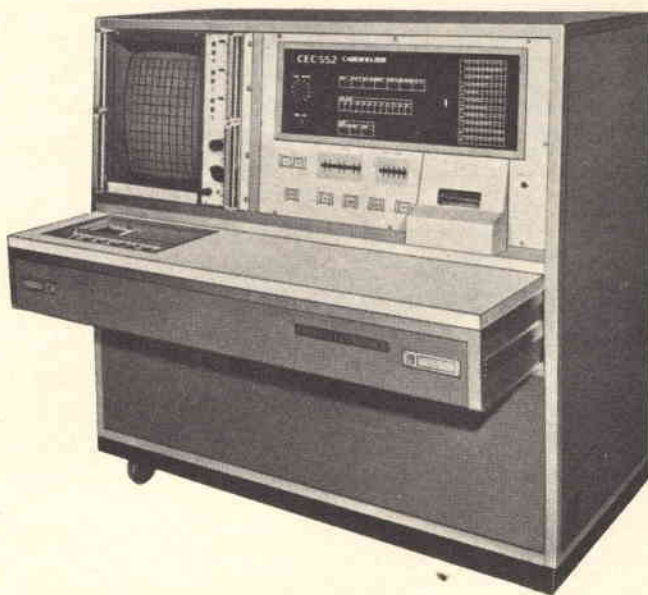
Fig. 9 - Apparecchiatura fissa per cardiologia costruita dalla CEC - Chuo Electronics Co, Ltd. di Tokyo.
