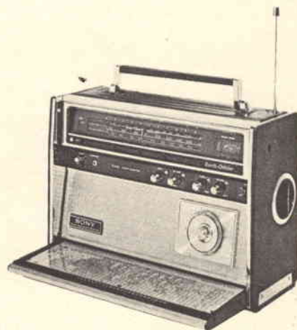
Fig. 1 - Ricevitore per gamma aerea, marina, FM, radiofari, medie, e corte SONY CRF-5090. 9 gamme alimentazione continua ed alternata (codice GBC ZZ/8102-00).
