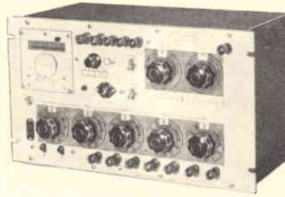
Fig. 4 - Fotografia del ponte di misura WT-5 il cui schema di principio è illustrato in figura 3.
