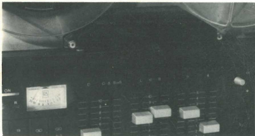
Tutti i potenziometri sono del tipo a slitta a spostamento lineare. Le loro funzioni sono ampiamente deducibili da questa foto.
