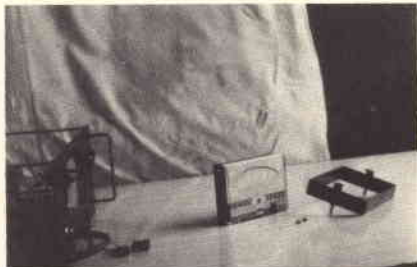
Fig. 9 - Telaioetto per il fissaggio di un normale strumento di misura ad un pannello.
