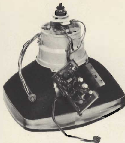
A sinistra: convenzionale tubo tricromico completo di circuiti per la convergenza dinamica. A destra: un cinescopio per TVC Trinitron della Sony.
