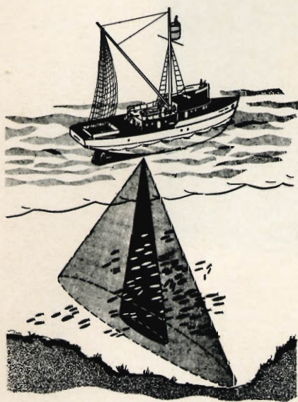
Fig. 8 - Esempio di ecometro o scandaglio ultrasonoro a doppio raggio. L'area ristretta è impiegata per la navigazione, quella più ampia per individuare i banchi di pesce.
