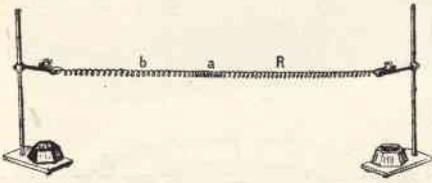
Fig. 12 - Propagazione longitudinale di un movimento vibratorio.
