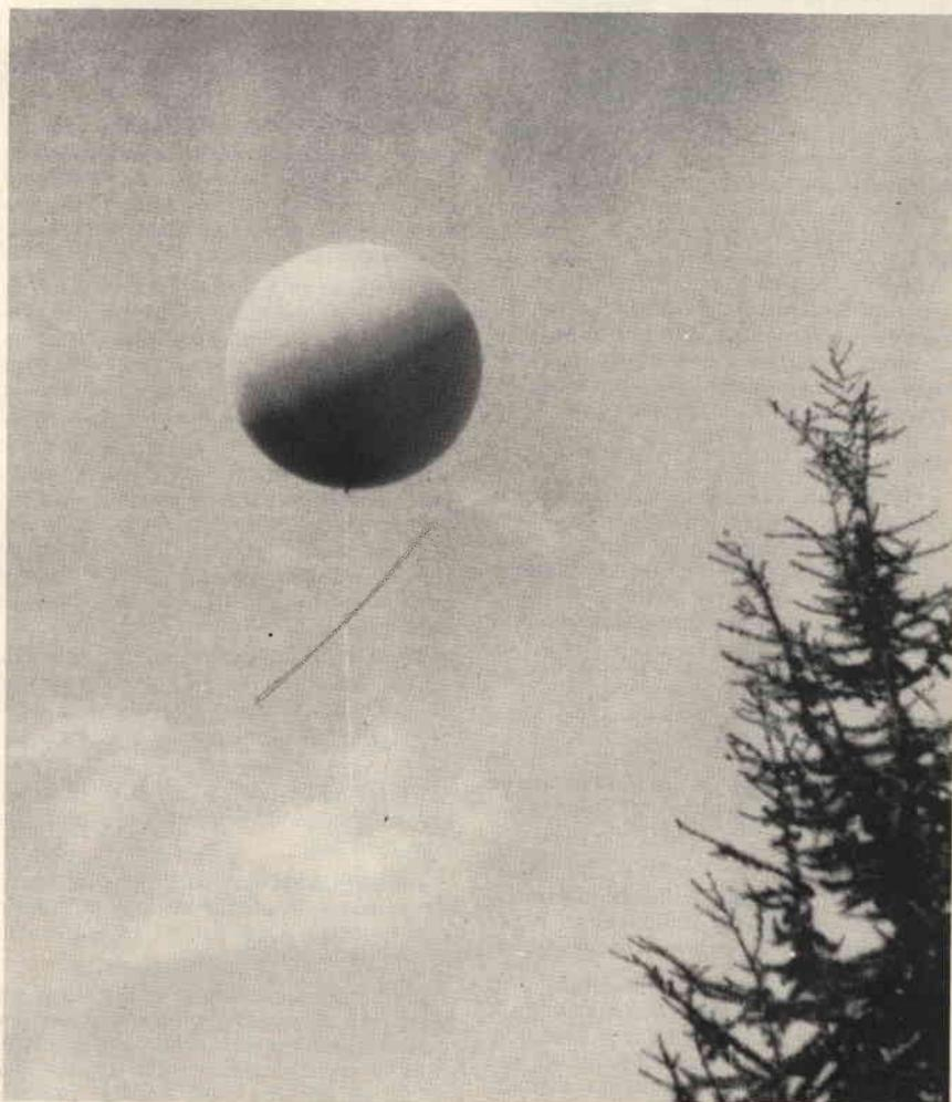
Fig. 1. - Pallone per esperimenti di ricezione di emittenti UHF a varie quote.
