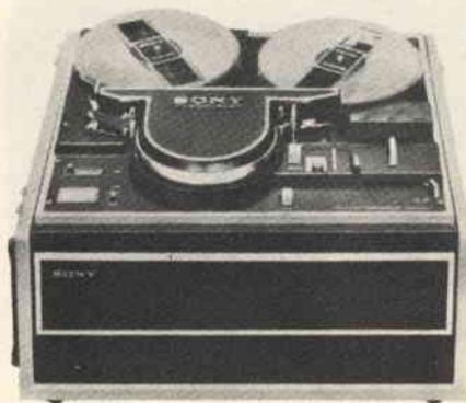
*Videoregistratore Sony mod. CV-2100-ACE; esso consente di registrare e riprodurre le immagini e i suoni contemporaneamente sia delle emissioni televisive che dei segnali provenienti da una telecamera.*
