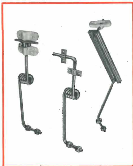
Fig. 9 - Alcuni tipi di carrelli in filo di acciaio. Questi carrelli hanno il pregio di ruotare, per cui il modello può sterzare come un aereo vero.
