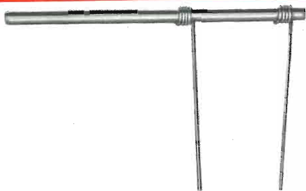
Fig. 3b - Una mina tipo 6B, tenerissima, può essere usata per realizzare un resistore variabile dal valore compreso tra 1,5 e 0,05Ω come questo illustrato.
