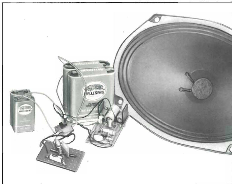
Fig. 5 - Aspetto del generatore di rumore bianco completo del relativo amplificatore, a montaggio ultimato.
