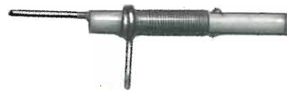
Fig. 2 - Compensatore industriale realizzato secondo la tecnica illustrata nella figura 1. I risultati offerti dagli esemplari «fatti in casa» non si discostano gran che da quelli dei modelli del genere qui fotografato, purché la ceramica impiegata sia di elevata qualità.
