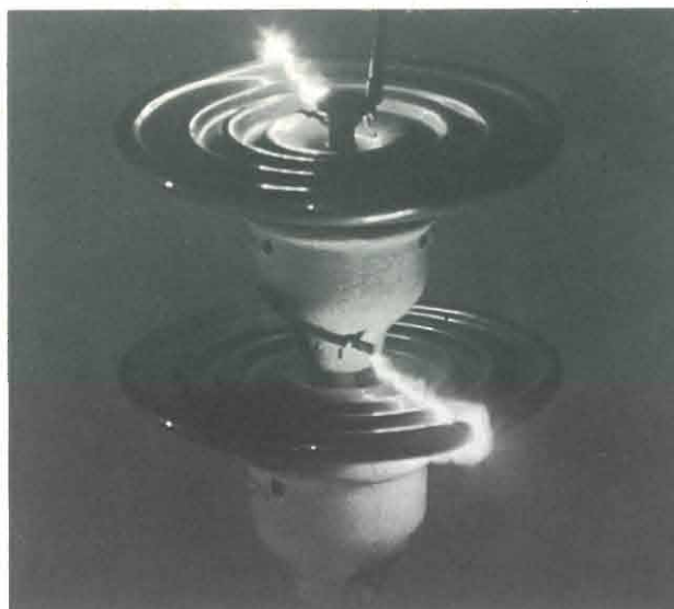
In copertina: Scarica su isolatore ceramico per alta tensione sottoposto ad una tensione di punta di 250 kV.
