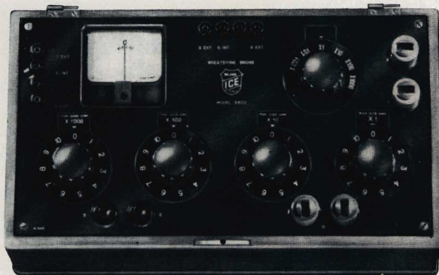
Fig. 3 - Ponte di Weatstone di elevata precisione per la misura di resistori da 0,01 \Omega fino a 10 M \Omega .
