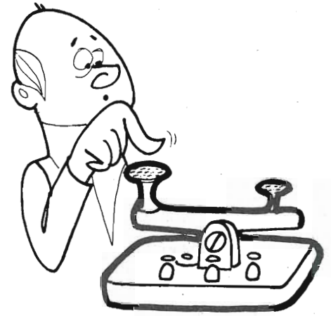
Fig. 10 - Per trasmettere a mano un messaggio codificato, Morse realizzò un manipolatore che chiudeva o apriva il circuito di trasmissione costituito da una linea, durante periodi di tempo più o meno lunghi a seconda che si trattava di una linea o di un punto. Un operatore bene addestrato poteva facilmente trasmettere da 900 a 1.200 parole all'ora.
