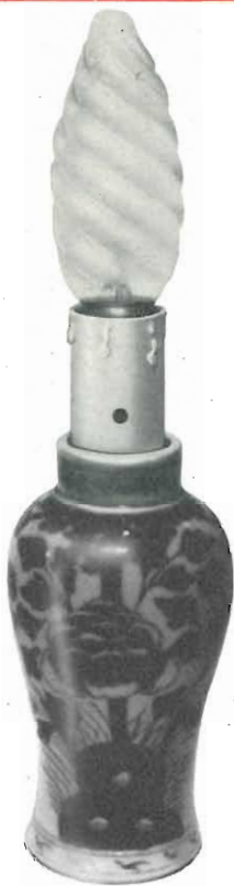
Fig. 4 - Aspetto della candela montata su di un vasetto ceramico che contiene la pila.
