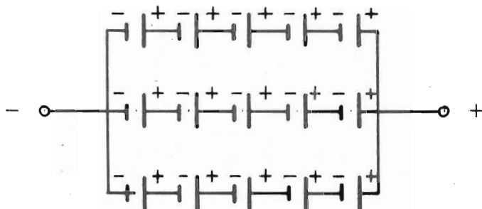
Fig. 9 - Collegamento misto serie-parallelo di pile ed accumulatori.
