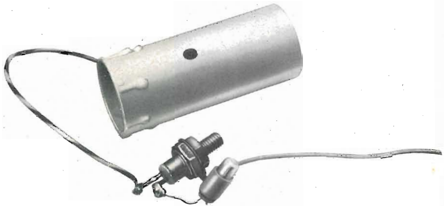
Fig. 5 - SCR e fotoresistenza: i due formano il cuore del nostro apparecchio. In secondo piano si vede il fusto della finta candela.
