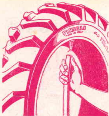
Fig. 4. — Distaccare di quando in quando, durante l'operazione di riempimento, il tubo di gomma della valvola, al fine di permettere all'aria residua all'interno del pneumatico di fuoriuscire.
