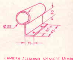
Fig. 3 - RETICOLO (Part. 1). Disco in celluloido avente il diametro di mm. 22,5 e lo spessore di mm. 0,3. Si traccia la croce di mira coll'ausilio di un utensile a punta. CANNA DI MIRA (Part. 2). Tubo in alluminio diametro esterno mm. 24 - diametro interno mm. 23. SUPPORTO PER CANNA DI MIRA (Part. 3). In lamiera di alluminio dello spessore di mm. 1,5.
