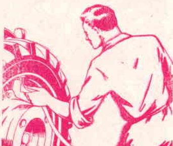
Fig. 6. — Riavvitare sul corpo della valvola il raccordo mobile ad eseguire il gonfiaggio ad aria fino al raggiungimento della pressione prescritta.
