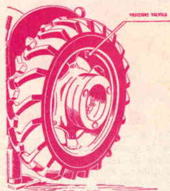
Fig. 1. — Sollevare la ruota del trattore e farla ruotare fino a che la valvola abbia raggiunto la posizione più alta sulla verticale.
