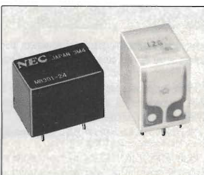
MR 301: Relè miniatura "LOW-PROFILE" in esecuzione flux free e sigillata - versioni: monostabile, bistabile, alta sensibilità - 1 contatto di scambio, portate: 5A; 120 Vca/30 Vcc; 600 VA/150 W 10A; 120 Vca/30 Vcc; 1200 VA/300 W - approvato UL - CSA
