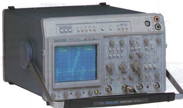
Foto A - Oscilloscopio Tektronix 2465 DVS da 300 MHz, a quattro canali; 2 mV/div., sensibilità verticale. Particolarmente adatto per misure in TV.
