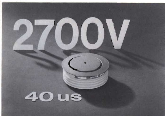
Fig. 2 - Tiristore RLT CSR 772, in contenitore a disco da 3 pollici. Nel chip assieme al tiristore è stato integrato un diodo, collegato in antiparallelo tra anodo e catodo del tiristore. Il tiristore possiede una caratteristica di bloccaggio asimmetrica. La porzione diretta della curva blocca tensioni fino a 2700 V. La corrente massima in fase di conduzione arriva fino a 675 A. Il tempo di recupero è 40 \mu s.
