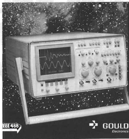
Foto C - Oscilloscopio a memoria digitale Gould 4035 da 20 MHz, a due canali; 2 mV/div., sensibilità verticale. 1 Kbyte di memoria per canale.
