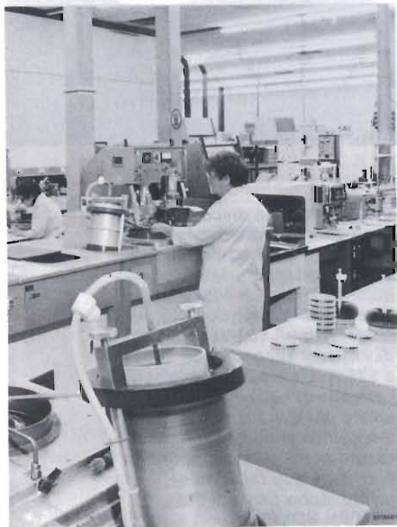
Preparazione dei chip dei tiristori di potenza prima dei processi di diffusione delle zone p e n. (Foto, BROWN BOVERI).
