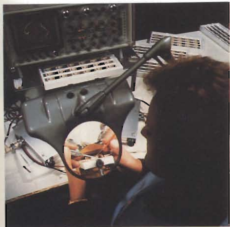
Fig. 9 - Inserimento dei trasformatori r.f. (d'accoppiamento e di adattamento di impedenza) nei circuiti del modulo.
