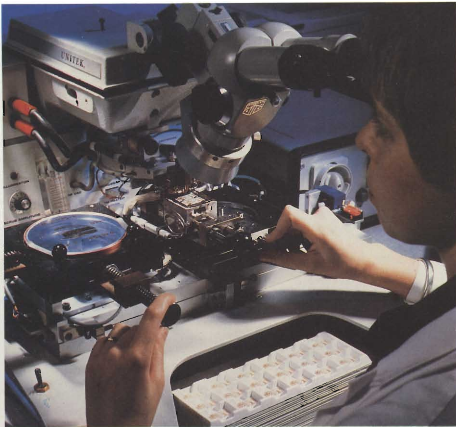
Fig. 8 - Effettuazione dell'operazione di bonding eutettico tra chip e substrato di allumina. Questa operazione è facilitata e resa possibile da un sistema originale di concentrazione localizzato del calore richiesto dal bonding.
