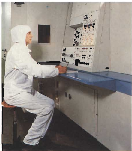
Fig. 4 - Il sistema di drogaggio mediante inserimento (o impianto) di ioni negli strati attivi che formano le giunzioni collettore/base e base/emettitore permette di ottenere giunzioni molto sottili, attraversabili quindi in tempi brevissimi da parte dei portatori di cariche. Questo permette di ottenere frequenze di taglio di valore molto elevato. L'apparecchiatura per l'impianto degli ioni presentata in questa figura è una delle più potenti e più avanzate attualmente esistenti.
