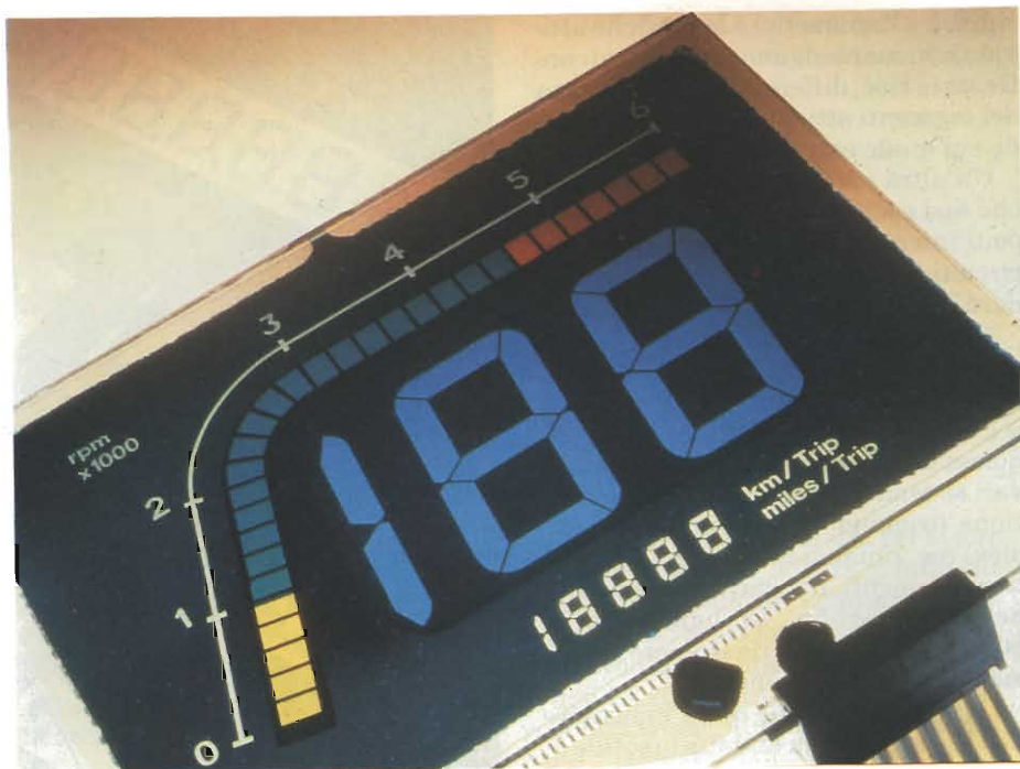
Fig. 4 - Prototipo Videlec di display integrato (VID) destinato al settore dell'auto. Il chip dell'integrato è fissato con un processo di bonding sul vetro dell'LCD. Il sistema di comando attuato dal chip è multiplex, modo 1:2.
