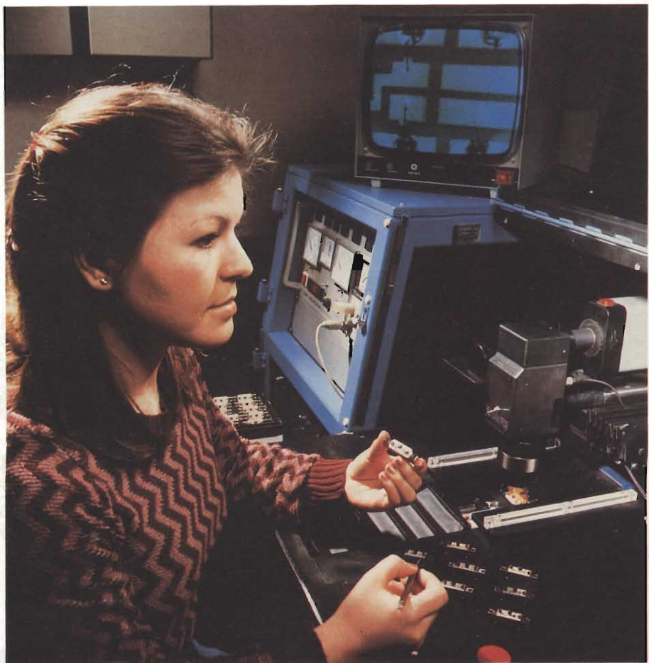
Fig. 9 - Inserimento dei trasformatori r.f. (d'accoppiamento e di adattamento di impedenza) nei circuiti del modulo.
