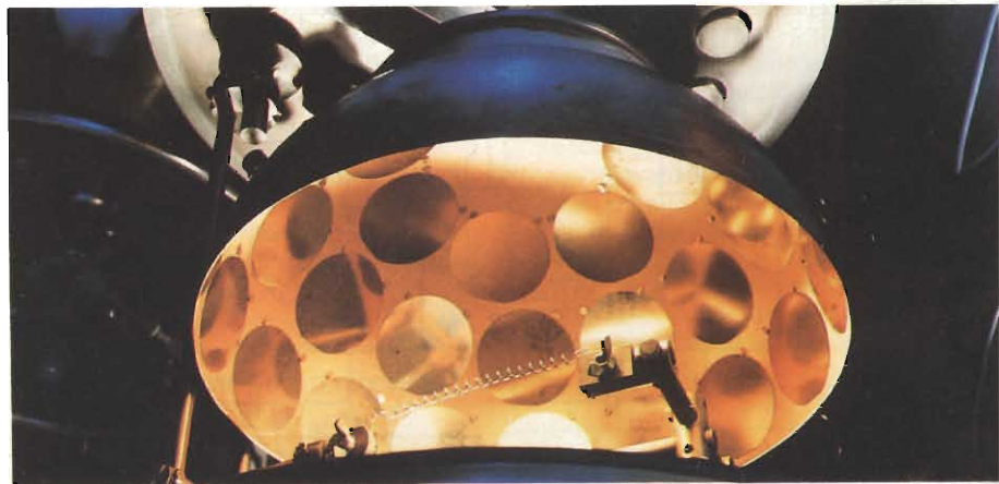
Fig. 7 - L'adesione perfetta a caldo (bonding eutettico) tra superficie del chip e substrato di allumina è resa possibile solo rivestendo mediante oro la superficie del chip a contatto con il substrato.
