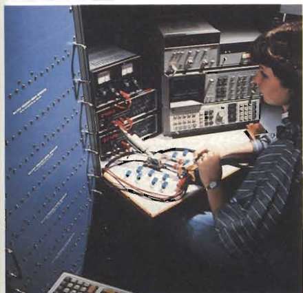
Fig. 11 - Verifica dei più importanti parametri elettrici dei moduli già muniti di cappuccio. Vengono controllati: battimento semplice di seconda armonica, composito di terza armonica e modulazione incrociata. Il sistema di controllo è computerizzato. Può verificare il funzionamento dei moduli alle frequenze di lavoro di oltre 94 canali TV fino alla frequenza di 600 MHz.
