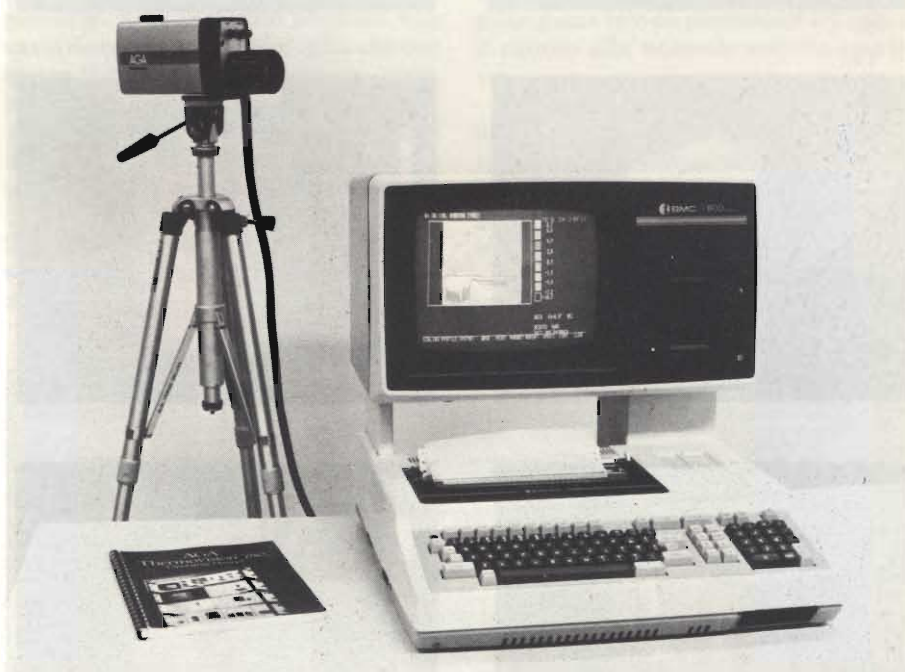
Fig. 4(a) - Sistema termografico AGA THERMOVISION completo di sistema digitale per la presentazione delle immagini termiche a colori ed a frequenze TV. (b) - Sistema termografico AGA THERMOVISION completo di personal computer per l'elaborazione dei termogrammi.
