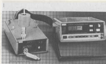
Esempio tipico stazione misura microonde, ad agevole impiego/costo contenuto, realizzabile col Mod. 7000A NARDA e con microwave unit (opzionale) della stessa casa americana.
