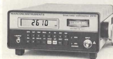
Voltmetro digitale controllato e microprocessore.
