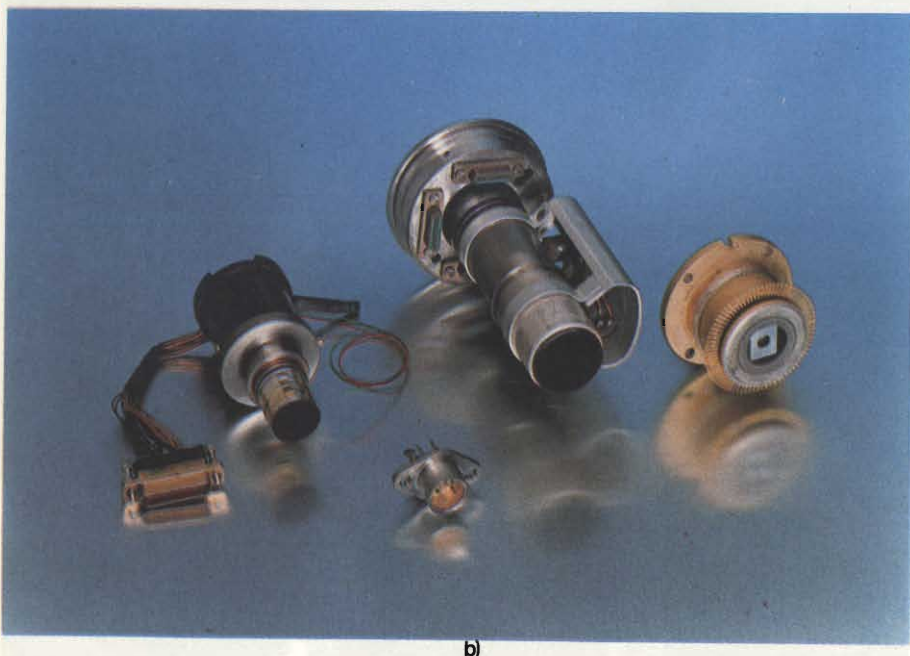
Fig. 2(a) - Finestre atmosferiche attraverso le quali le radiazioni infrarosse incontrano meno resistenza. Gli elementi che ostacolano il passaggio sono principalmente l'anidride carbonica (CO 2 ) e il vapore acqueo (H 2 O). (b) - Rivelatori di infrarosso a semiconduttori (tellururo di cadmio-mercurio) prodotti dalla Philips - Elcoma.
