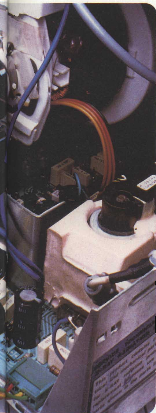
Una vista interna del monitor a colori ad elevata definizione CT 900. A destra si può vedere il trasformatore finale di riga e generatore dell'alta tensione (EAT).
