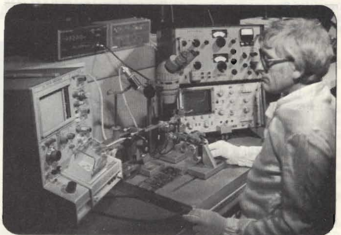
Due fasi nel controllo dei substrati impiegati negli oscillatori a microonde (sopra) ispezione ottica. (sotto) Collaudo.
