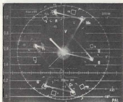
Fig. 9 - Diagramma vettoriale del segnale a barre di colore con interruttore PAL aperto.
