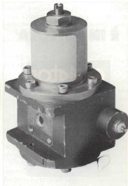
Fig. 7 - Esempio di oscillatore a diodo IMPATT (JS1000). A 11 GHz, dà una potenza d'uscita di 500 mW. Viene impiegato sia nei ricevitori che nei trasmettitori.
