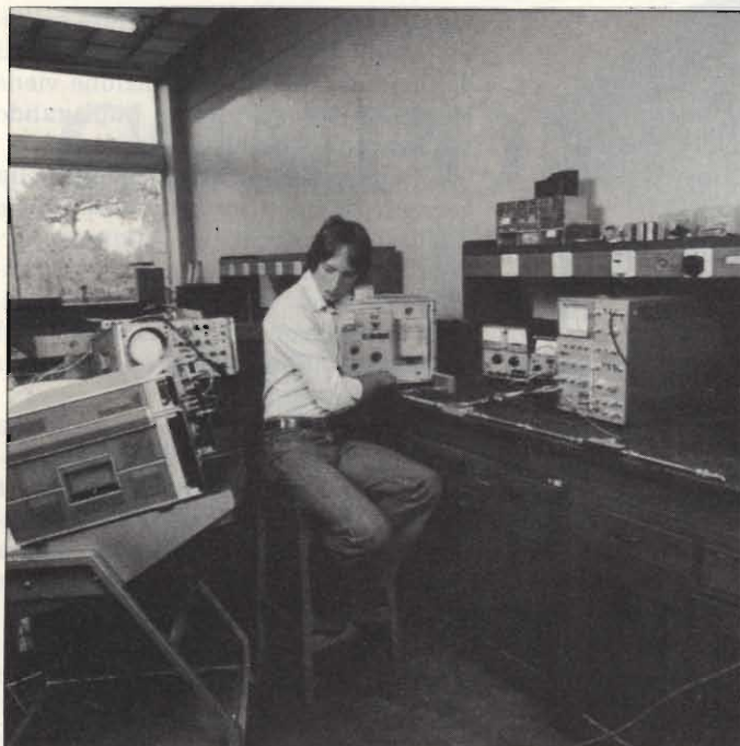
Banco di collaudo di un oscillatore da 300 W a 25 GHz, realizzato con diodo TRAPATT.
