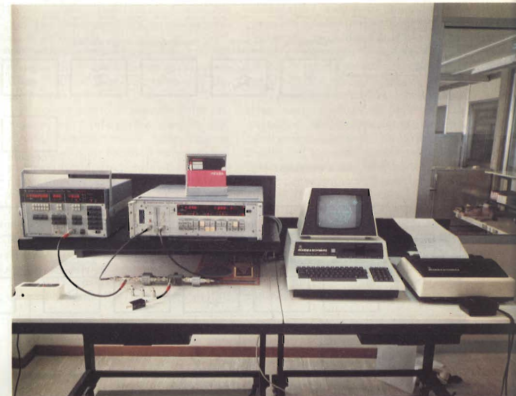
Analizzatore di reti R.S. selettivo, completamente computerizzato. È in grado di operare nella gamma da 400 kHz a 2 GHz. Può effettuare sia misure scalari che vettoriali con la risoluzione del centesimo di dB. È corredato di molti programmi fra cui misure di impedenza con correzione a 3 punti. Viene utilizzato essenzialmente per la progettazione e per il Controllo Statistico di Qualità (Laboratorio misure RO.VE.R.)
