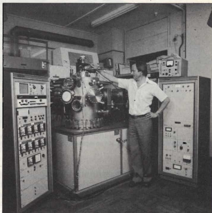
Forni per la produzione degli strati epitassiali di arseniuro di gallio nei transistori FET per microonde.
