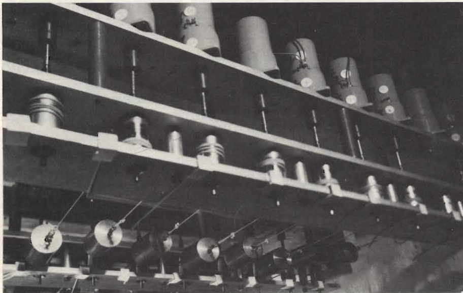
Prova di vita per piccoli motori: il motore è fatto continuamente girare sotto carico.
