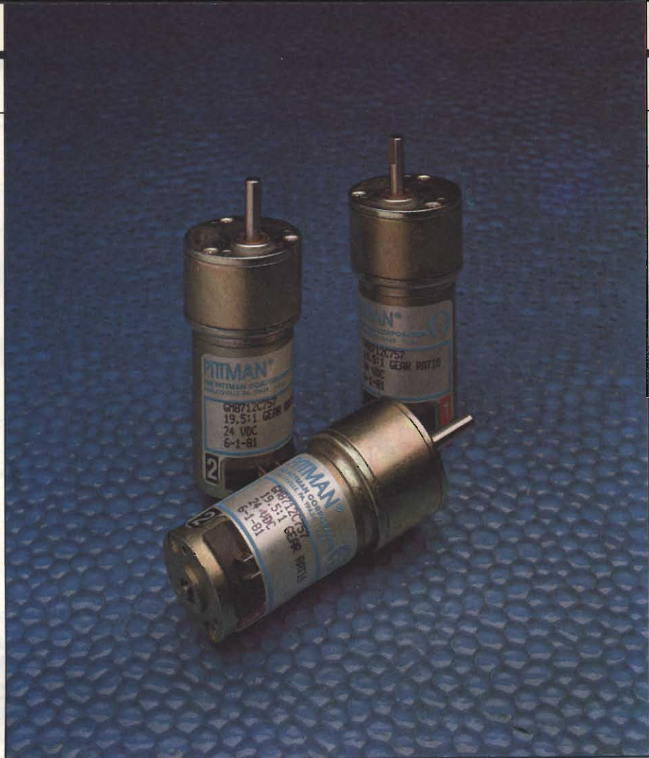
Motorini in corrente continua con statore a magneti permanente e ingranaggi di riduzione incorporati. Rapporto di riduzione dei giri 19,5:7; Alimentazione 24 Vcc.
