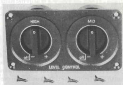
Fig. 3 - Doppio regolatore ad L LC 57 HM che serve ad adattare il livello degli altoparlanti dei toni alti e dei toni medi.
