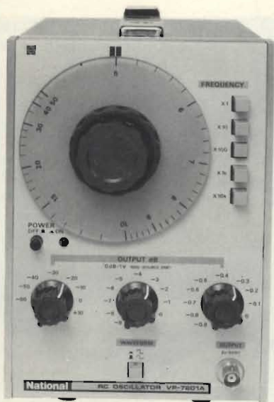
Oscillatore con lo 0,005% di distorsione da 20 Hz a 20 kHz.
