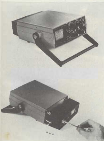
Oscilloscopio Travelscope da 15 MHz per la manutenzione, funzionante a rete e a batteria.
