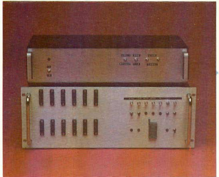
Fig 1 - Vista del frontale dei contenitori del Computer e del Terminale Video. Si noti, sul primo, la disposizione dei comandi, lo zoccolo Textool ZIP (Zero Insertion Pressure) per il Programmatore di Eprom e, a sinistra, le 12 femmine dei connettori che portano all'esterno le linee del Data Bus, Address Bus, Timing, Control, nonché tutte le linee di I/O disponibili.
