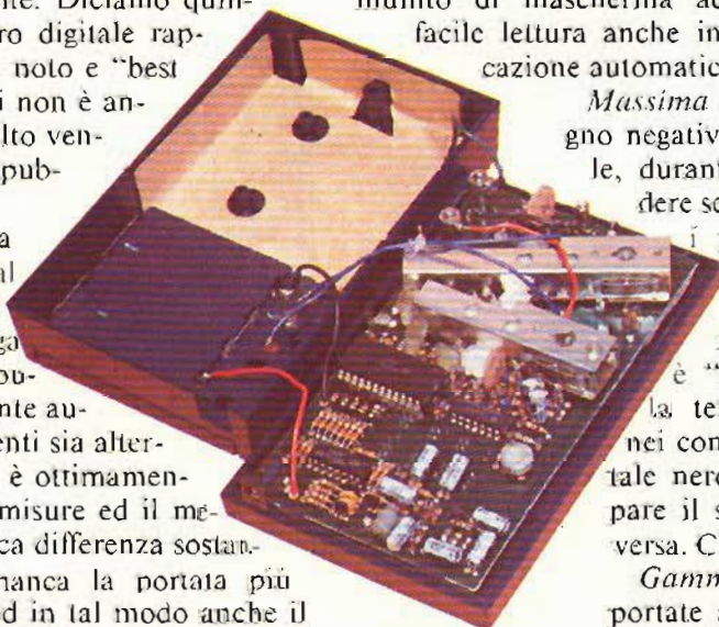
Vista interna del multimetro digitale SOAR ME-521DX.
