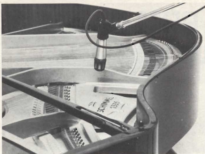
Foto n. 5 - L'uso di un microfono dinamico è riservato alle applicazioni in cui è necessaria più robustezza che qualità come nel caso di esecuzioni dal vivo di musica leggera.
