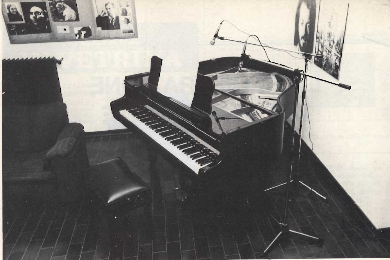
Foto n. 1 - Disposizione dei microfoni per la registrazione di musica classica.
