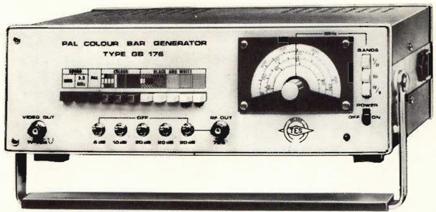
Fig. 4 - Il generatore di barre di colore Modello GB 176, funzionante sul sistema PAL.
