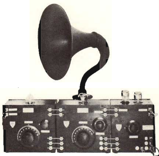
Fig. 6 - Un radiorecettore d'avanguardia realizzato nel 1923, con relativo altoparlante a tromba.
