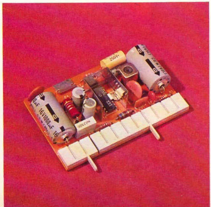
Fig. 9 - Fotografia del modulo (T) del canale audio.
