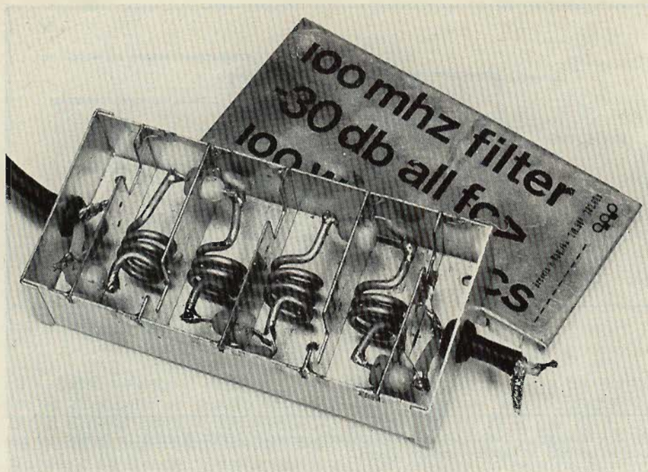
Vista interna del filtro passa basso a montaggio ultimato.
