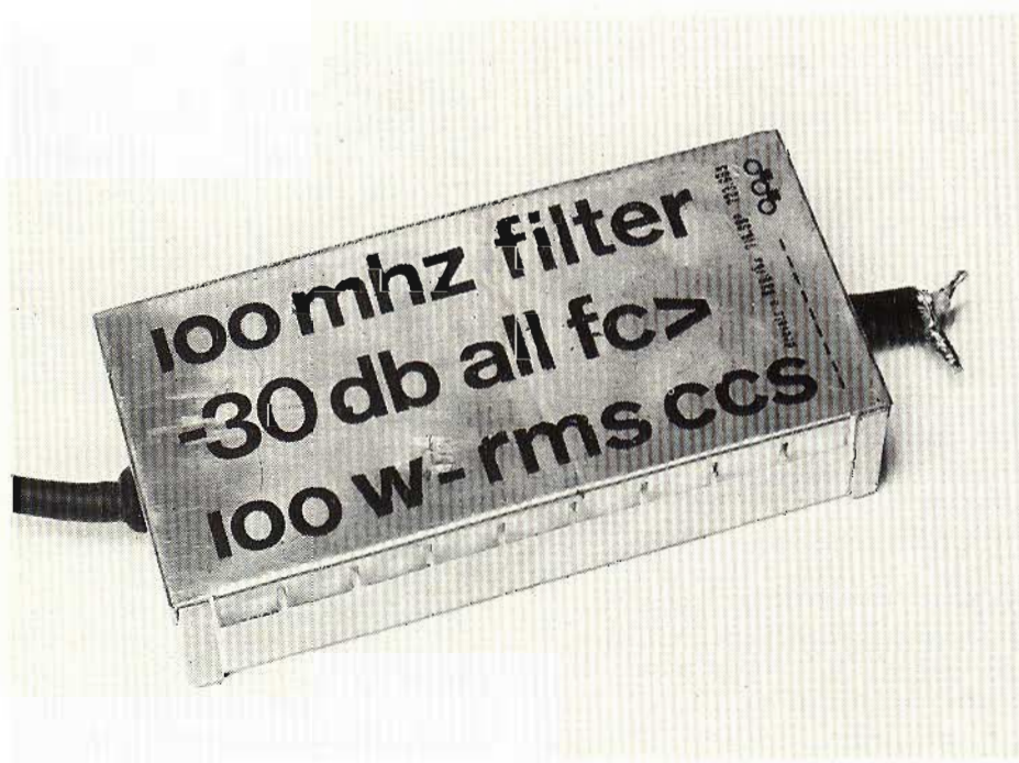
Prototipo del filtro passa basso descritto nell'articolo.
