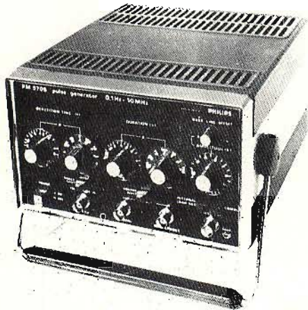
Fig. 2 - Per il laboratorio didattico è sufficiente un generatore d'impulsi da 10 MHz con un'ampiezza di 15 V e uscita TTL compatibile. I comandi frontali sono una necessità — preferibilmente come nel PM 5705 Philips, con scale che riducono il tempo di messa a punto e consentono di risparmiare le apparecchiature altrimenti necessarie per il controllo dell'uscita del generatore.
