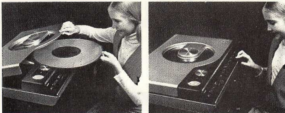
Fig. 1-A - Apparentemente usare il videogrammofono Philips-MCA è un gioco da ragazzi. Si inserisce il disco con il lato inciso in giù, si chiude il coperchio e si preme il pulsante d'avviamento.
