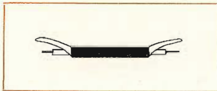
Fig. 3 - Preparazione dei due spezzoni di cavetto schermato.
