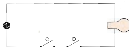
Fig. 2 - Circuito elettrico equivalente alla funzione «E». La lampadina si accende solo se C e D sono chiusi.
