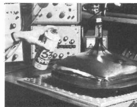
Fig. 10 - Esempio di applicazione del «Graphit-Spray 33» sul retro di un televisore, per costituire uno strato perfettamente conduttivo, di notevole resistenza. Lo stesso materiale può essere usato anche per riparare schermi interrotti, e per creare effetti di schermaggio.
