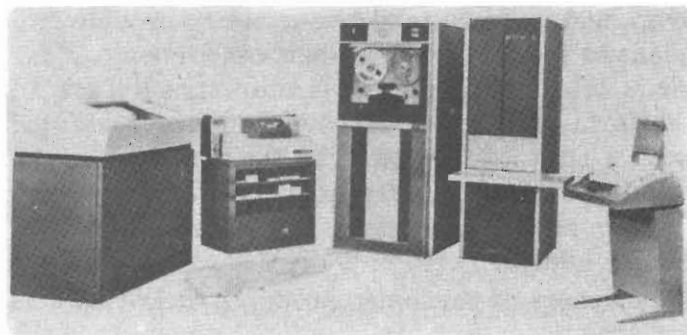
Fig. 17 - Il primo minicomputer commerciale a 12 bit introdotto dalla Digital Equipment nel 1963.
