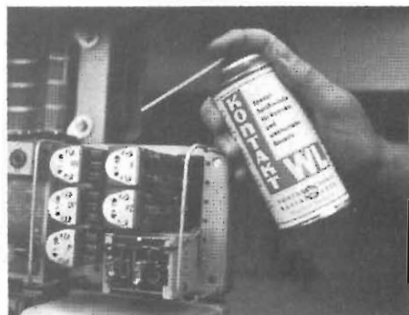
Fig. 2-A - Pulizia in profondità dei contatti di un relè, mediante il «Kontakt WL Spray WASH».
