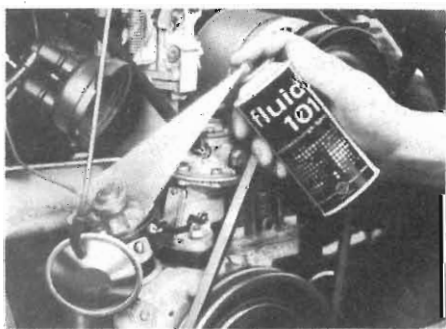
Fig. 12-A - Il «Fluid 101» è molto utile per eliminare gli inconvenienti che determinano i guasti di accensione a causa della presenza di umidità nei distributori elettrici per motori a scoppio, ed in tutti gli altri casi in cui la presenza di acqua impedisce il regolare funzionamento.
