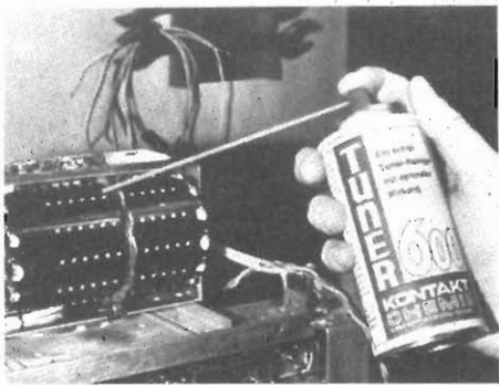
Fig. 5 - Due esempi tipici di impiego del «Tuner 600», per la pulizia e la protezione di sintonizzatori a tamburo per VHF (a sinistra), ed a semiconduttori per UHF (a destra).
