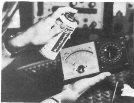
Fig. 11 - Particolarmente utile per i casi in cui si desidera evitare i fenomeni dovuti alla presenza di energia statica è il prodotto denominato «Antistatik-Spray 100»: il prodotto può essere applicato sul pannello di strumenti ad indice, su dischi grammofonici, sulle superfici di arredi, eccetera, per eliminare tutti gli inconvenienti normalmente dovuti all'accumulo di cariche elettrostatiche.
