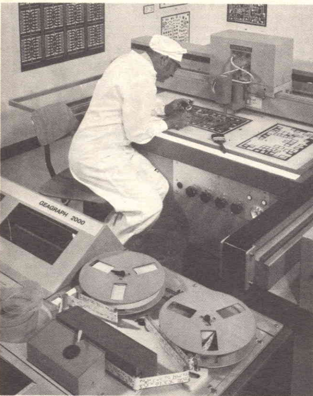
Fig. 85 - Le maschere, dopo il controllo ottico, subiscono eventuali ritocchi. Qui, al controllo ottico, si affianca quello effettuato mediante un calcolatore.
