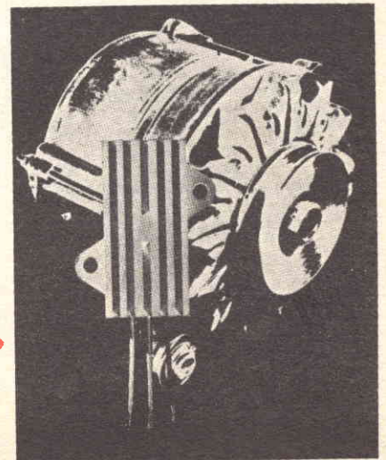
Fig. 14-B - Fotografia di un alternatore di tipo moderno, al quale è applicato il regolatore elettronico di cui alla figura 14-A.
