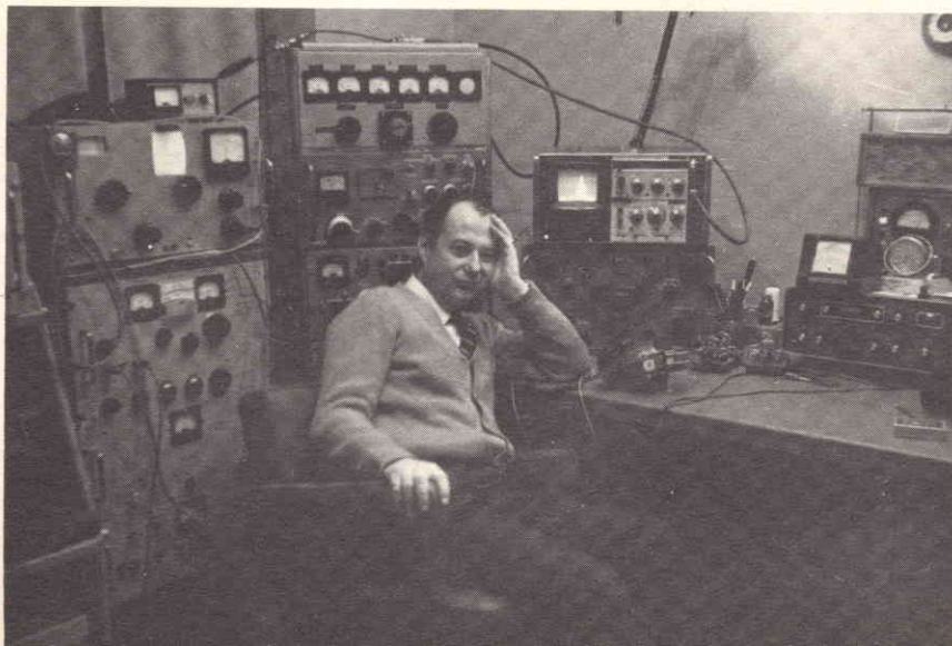
Fig. 5 - Ecco I2AMC nel suo «Shack» di lavoro. Si notino sul tavolo accanto alla cuffia, i due tasti semiautomatici per telegrafia sempre pronti ad operare, connessi fra loro in parallelo; uno di essi è predisposto per altre velocità abbondantemente oltre i 100 caratteri al minuto e l'altro per velocità inferiori.
