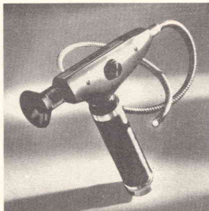
Fig. 1 - Strumento Fiberscope, per controlli a distanza di punti difficilmente accessibili, modello FS-100.
