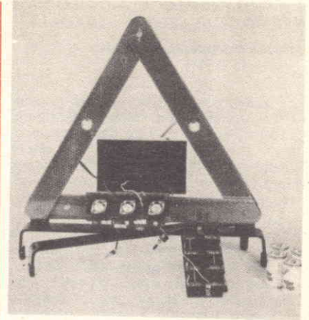
Fig. 19 - Fotografia del lampeggio per triangolo, così come è stato costruito dal progettista originale, ripresa con l'apparecchiatura smontata per chiarire la posizione di alcuni componenti.
