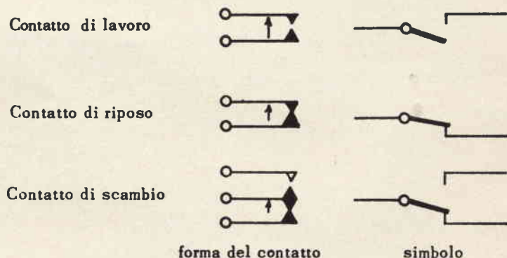
Fig. 8 - Contatti tipici di lavoro, di riposo e di scambio di un relé e relativi simboli.
