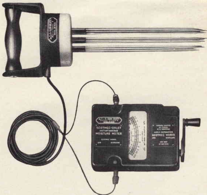
Fig. 10 - Misuratore portatile di umidità per cereali Scotmec-Oxley.
