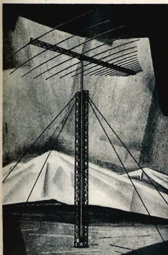
Fig. 4 - Antenna Hy-gain da 4-30 MHz, logaritmica periodica.
