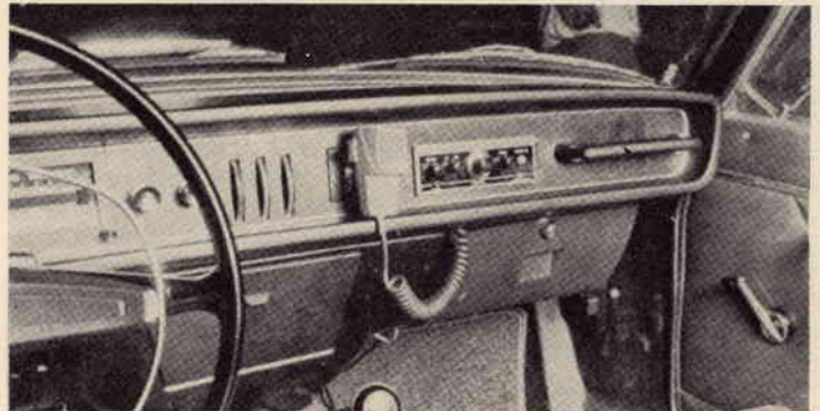
Fig. 3 - Rice-Trasmittitore a transistori di costruzione danese, da 15 W.
