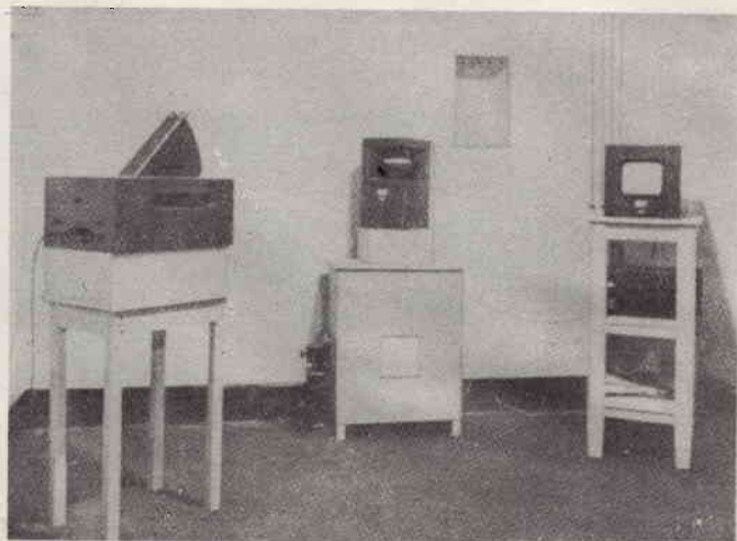
Fig. 7 - Una telecamera con l'iconoscopio realizzata nel 1936 dal russo V.K. Zworykin (Philips).
