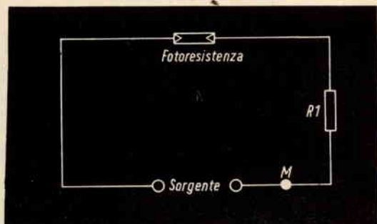
Fig. 3 - Circuito di base di una fotoresistenza.
