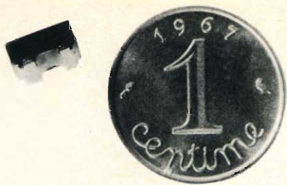
Fig. 10 - Nuovi condensatori al tantalio di ridotte dimensioni senza terminali filiformi e direttamente saldabili tramite due metallizzazioni laterali.
