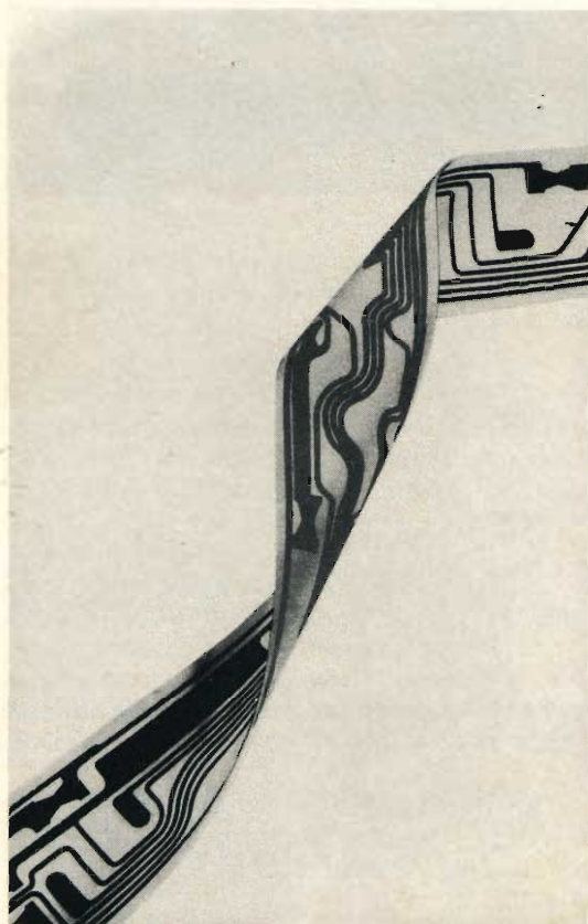
Fig. 11 - Sempre più diffusi sono i circuiti stampati flessibili, realizzati su pellicola di poliestere (« BXL »).
