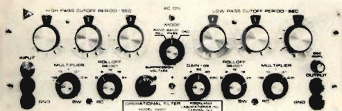
Fig. 7 - Filtro operazionale (attivo e passivo) per frequenze da 0,001 Hz a 10 kHz dei « Rockland Labs., Inc. ».
